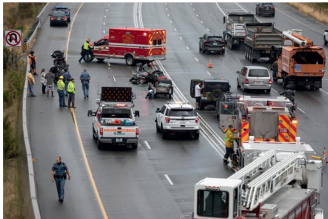
Figura 5-4 O posicionamento correto de um veículo de emergência.
