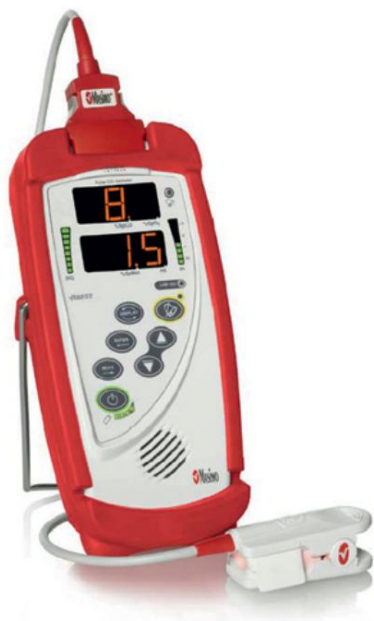
Figura 13-19 Monitor pré-hospitalar de monóxido de carbono Masimo, Rad-57.
