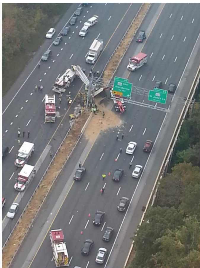
Figura 5-5 A colocação dos dispositivos de delimitação de tráfego.
